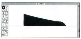
Ecco come ottenere forme abbastanza complesse come il musetto e la presa d'aria. Si utilizza una tecnica per rivoluzione di un profilo ("Revolve" dal menu "Operations"). Con Illustrator tracciamo un profilo simile a quello in figura (per il musetto), si posiziona anche la guida che diverrà l'asse di rotazione, si copiano disegno e guida e si incolla il tutto come al solito in Dimensions.
